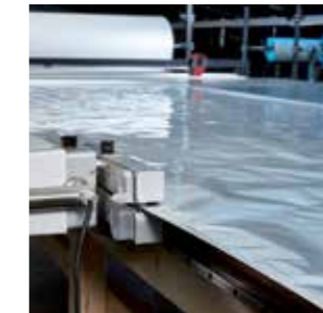
Versiegeln mit Durchlaufsiegelgerät
