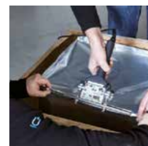
Ansiegeln des Deckels
