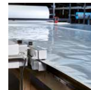
Versiegeln mit Durchlaufsiegelgerät
